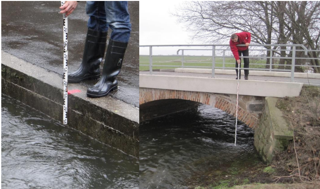
Abb. 6: Markierung und vorläufige Einmessung an einer Stützmauer (links) und einer Brücke (rechts)
